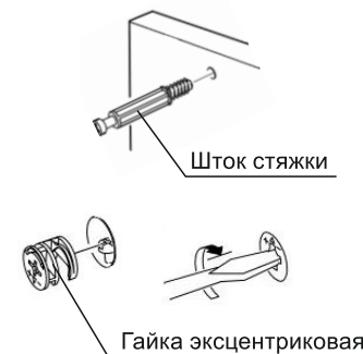
Схема 4. Установка стяжки эксцентриковой
